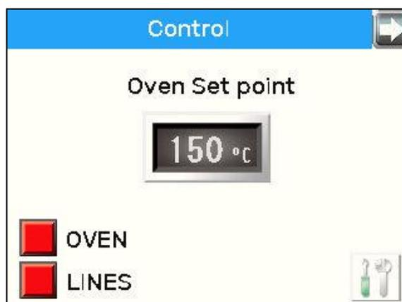
A partir de cette page, il est possible de mettre en marche le chauffage du four et des lignes chauffées. Le champ 'Oven Set Point' permet de fixer la consigne de température du four.
