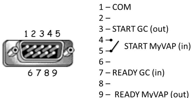
Le connecteur DB9 est conçu pour être connecté à un GC 7890 Agilent avec un câble droit DB9 M/F standard. Il permet de synchroniser le MyVap et le GC :
