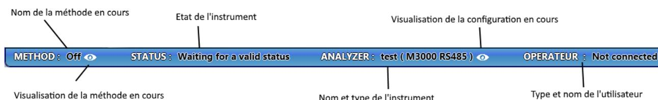
Au passage du curseur sur le champ correspondant à l'analyseur, des informations complémentaires sur la configuration de l'analyseur apparaissent.
