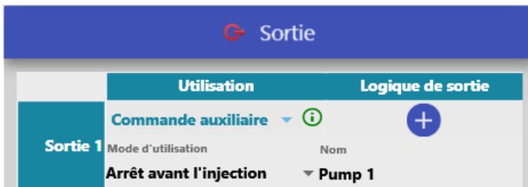
Le mode **non utilisé** est utile si on a configuré une pompe et qu'on veut la mettre en attente pendant quelque temps ou si on veut la piloter par DDE.
