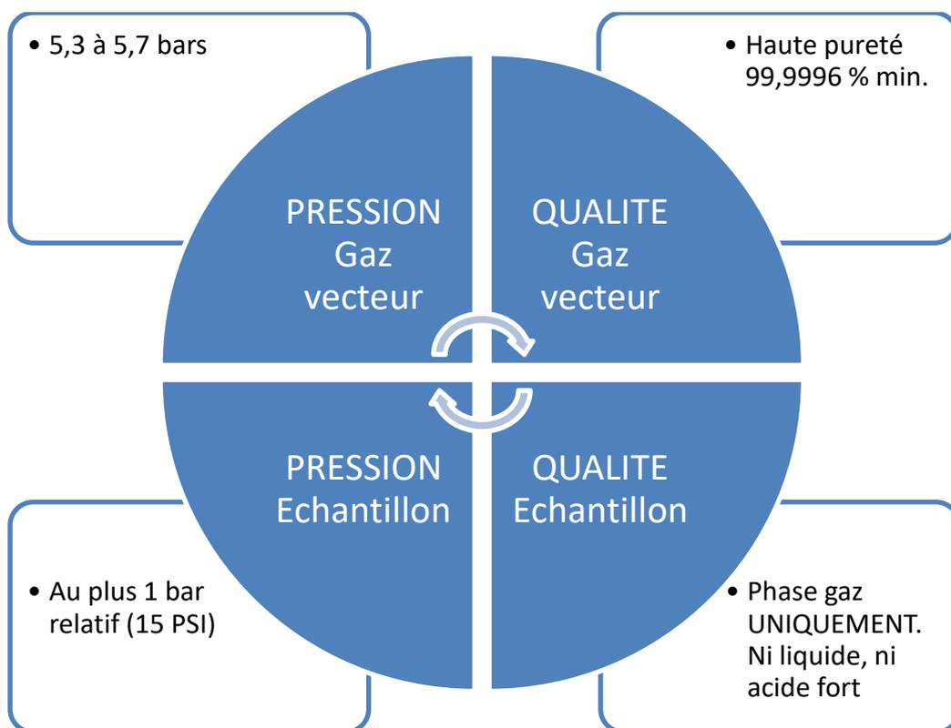
Ne pas respecter ces règles augmente fortement le risque d'endommager votre instrument. Toutes les procédures standards pour utiliser le MicroGC découlent de ces 4 règles d'or : la qualité du gaz vecteur nécessitera une purge du tube pour assurer ce niveau de qualité.
