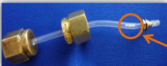
Présence de particules dans le tube PTFE après analyse de PE-HD
