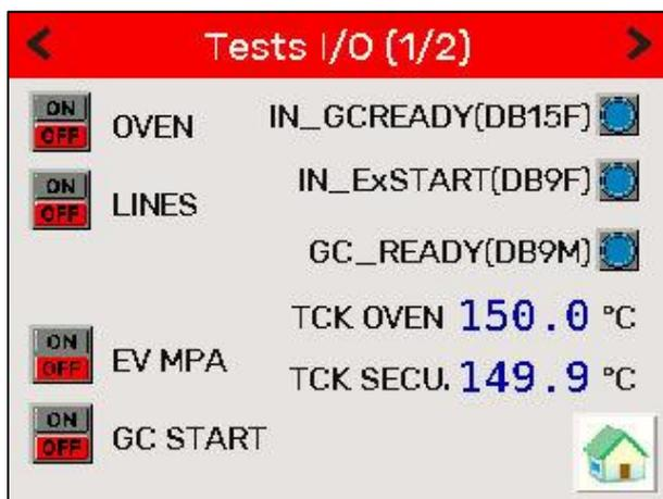
A partir de cette page, vous pouvez mettre en marche soit le four uniquement soit les lignes chauffées. Vous pouvez piloter la vanne de mise à pression atmosphérique et surveiller la température du four et de la sonde de sécurité ainsi que l'état des entrées logiques.
