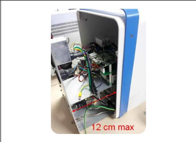
Pour ouvrir totalement le châssis, le câble du bouton de la face avant doit être déconnecté de la carte principale.
