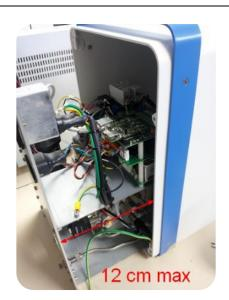
Pour ouvrir totalement le châssis, le câble du bouton de la face avant doit être déconnecté de la carte principale.
