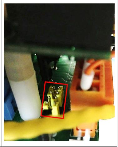
$\begin{array}{c} \text{Configuration pour } \mu\text{GC 490}: \text{seulement} \\ \text{deux jumpers sont présents} \end{array}$
