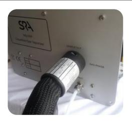
**OPTIONNEL** La ligne de transfert chauffée peut être connectée à la sortie du vaporiseur.
