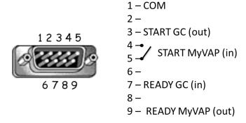
Le connecteur DB9 est conçu pour être connecté à un GC 7890 Agilent avec un câble droit DB9 M/F standard. Il permet de synchroniser le MyVap et le GC :
