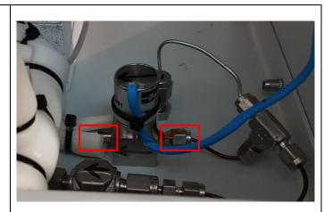
Dévissez les 2 vis de fixation sur le panneau avant
