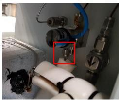
Retirez les 2 vis de fixation du vaporiseur et le retirer
