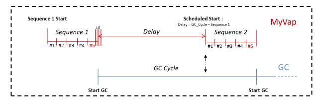
Lorsqu'un temps de cycle GC est spécifié, le délai entre les séquences est estimé en supposant que chaque séquence dure le même temps ( $\Delta \ll$  Séquence et  $\Delta \ll$  Temps de cycle GC).
