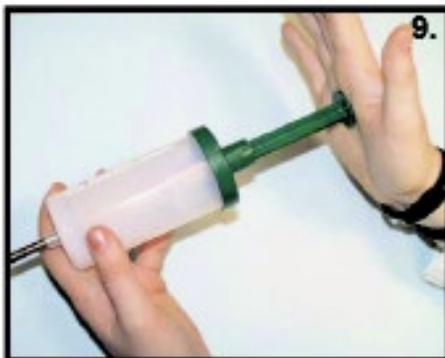
**9.** Faites circuler le volume d'air précédemment piégé, au travers du tube de prélèvement en poussant le piston sur toute la longueur du corps principal. Poussez doucement et régulièrement, le transfert doit durer environ 10 secondes.
