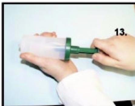
**13.** Purgez l'échantillonneur BioVoc 3 fois consécutivement par action du piston. Remplacez finalement le piston en position haute, c'est-à-dire du côté de la partie verte du corps principal. L'échantillonneur est maintenant prêt pour une nouvelle utilisation. Répétez l'opération dans son intégralité pour obtenir un second échantillon de la personne.
