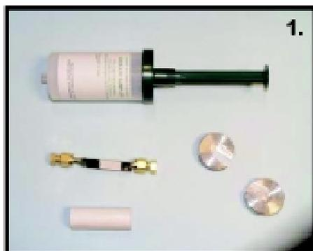
**1.** La photo montre l'échantillonneur BioVoc avec le piston vissé dans le corps principal. Le tube de prélèvement en acier inoxydable fermé avec des bouchons 1/4 de pouce, le raccord individuel jetable et l'outil d'ouverture et de fermeture des tubes.
