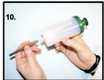
**10.** Comptez jusqu'à 5 puis retirez le tube de prélèvement de l'échantillonneur BioVoc.
