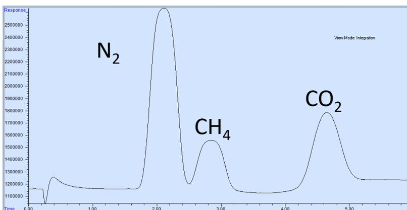
Analyse d'un échantillon de gaz à 100 mbar
