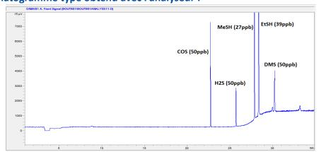
Analyse détaillée des soufrés dans le gaz naturel avec un détecteur PFPD
