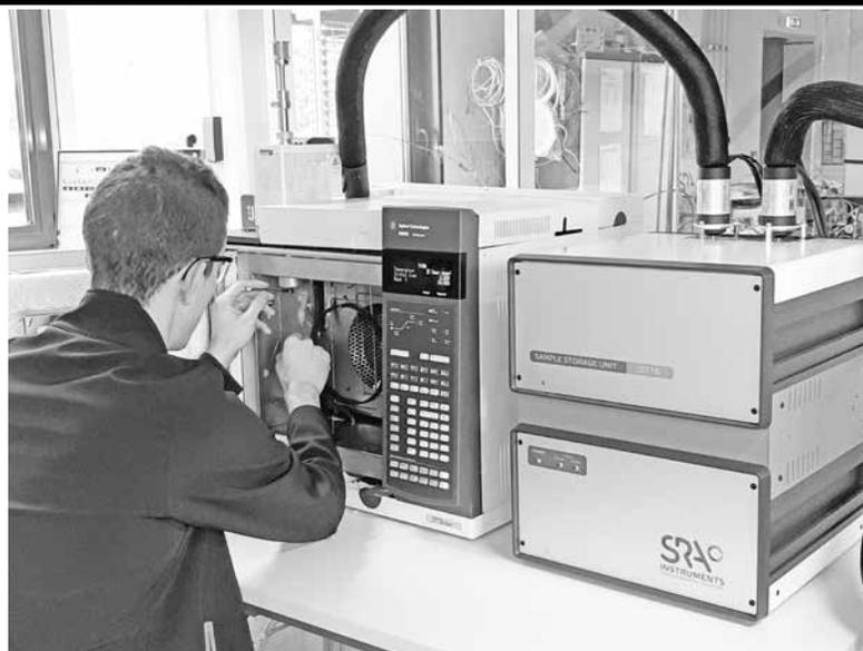
Ingénieur R&D manipulant un couplage TGA-IST16-GC-MSD
