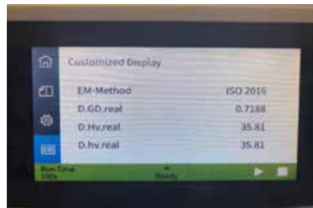
Figure 5. Résultats du calcul de la valeur calorifique affichés sur l'écran tactile du Micro GC Agilent 990 PRO.
