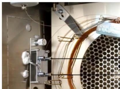
Une interface dédiée garantit, en sortie de la première colonne, le transfert total des analytes dont la séparation doit être entièrement préservée, vers la deuxième colonne.
