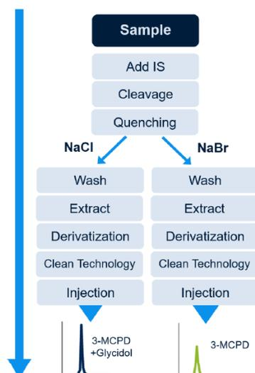
Figure 1 : Préparation des échantillons pour l'analyse indirecte de MCPD avec la méthode « DGF fast & Clean » automatisée avec la station de travail CHRONECT MCPD
